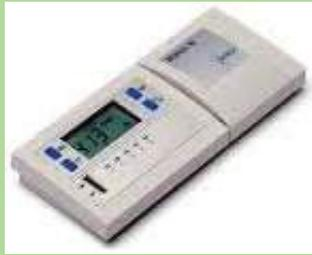
Strumento per la misurazione dell'HMF
