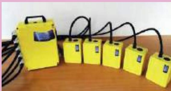
Fig. 5: Sistema di trattamento della varroasi con ozono.
