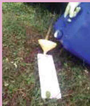
**Fig. 2 Il caricamento dell'erogatore BLVFormic con acido formico al 78%.**
