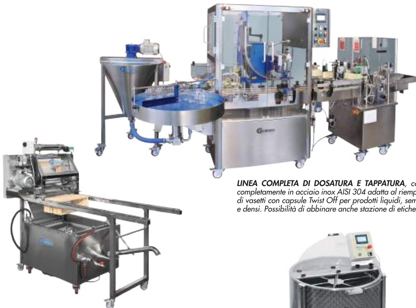
**LINEA COMPLETA DI DOSATURA E TAPPATURA**, costruita completamente in acciaio inox AISI 304 adatta al riempimento di vasetti con capsule Twist Off per prodotti liquidi, semi densi e densi. Possibilità di abbinare anche stazione di etichettatura.
