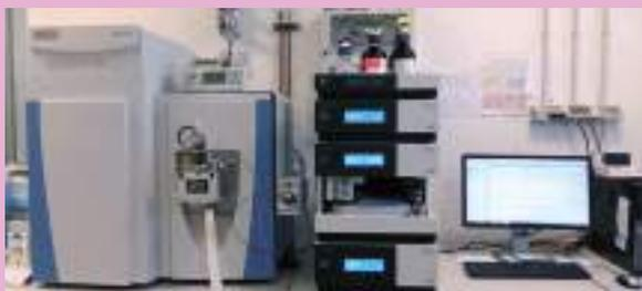
**Figura 1:** Apparecchiatura complessa composta da sistema per cromatografia liquida accoppiata a rilevatore spettrometro di massa ad alta risoluzione.
