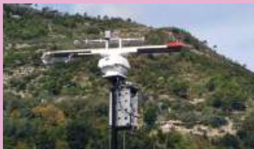
Fig. 5 - Il radar armonico per il tracciamento del volo dei calabroni
