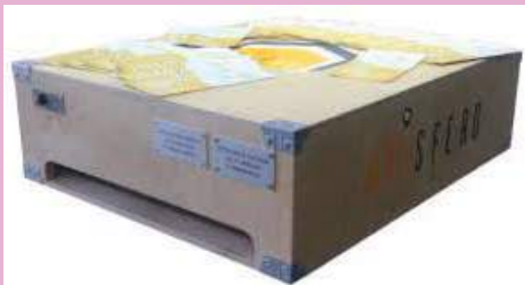
Scanner BVS per la conta della Varroa (Apisfero)
