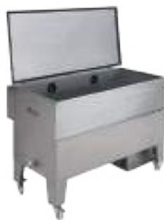
**Deumidificatori** a dischi singoli in acciaio inox AISI 304 con sistema di deumidificazione a “circuitto chiuso”. Si evita così di portare all’interno del deumidificatore odori o altri elementi presenti nell’ambiente circostante e di disperdere all’esterno le proprietà del miele. Così, il profumo e l’aroma vengono conservati al 100%. Il deumidificatore estrae circa 1-2% di umidità in 8 ore di lavoro.
