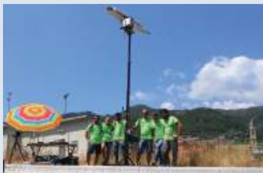
Fig. 4 - Radar armonico entomologico per il tracciamento del volo dei calabroni e l'individuazione dei nidi di V. velutina .
