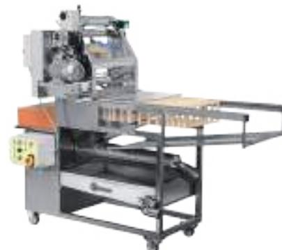
**Disopress** è una macchina compatta costruita per velocizzare il processo di disopercolatura. È composta da una disopercolatrice in acciaio inox funzionante con dei coltelli vibranti riscaldati che assicurano un taglio perfetto senza causare lo sbriciolamento dell'opercolo.
