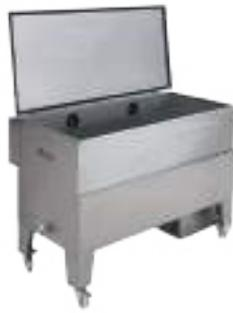
**Deumidificatori** a dischi singoli in acciaio inox AISI 304 con sistema di deumidificazione a "ciclo chiuso". Si evita così di portare all'interno del deumidificatore odori o altri elementi presenti nell'ambiente circostante e di disperdere all'esterno le proprietà del miele. Così, il profumo e l'aroma vengono conservati al 100%. Il deumidificatore estrae circa 1-2% di umidità in 8 ore di lavoro.
